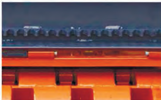
ЧЕТЫРЕ РЯДА КОНТРОНЖЕЙ ДЛЯ ПОЛУЧЕНИЯ МИНИМАЛЬНОЙ ФРАКЦИИ МУЛЬЧИ ЗА ОДИН ПОДХОД
