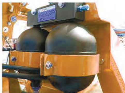
ОХЛАЖДЕНИЕ ГИДРАВЛИКИ, АЗОТНЫЙ АККУМУЛЯТОР
