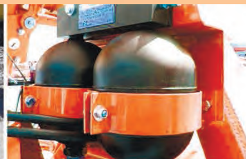
ОХЛАЖДЕНИЕ ГИДРАВЛИКИ, АЗОТНЫЙ АККУМУЛЯТОР
