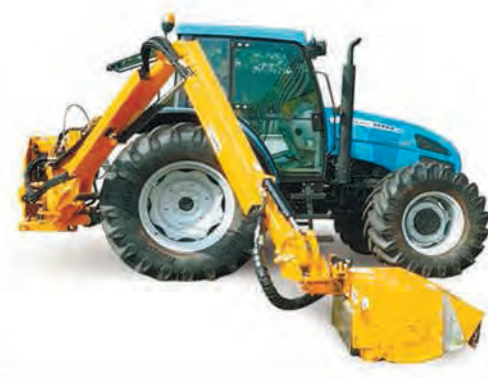
ИЗОГНУТАЯ СТРЕЛА ДЛЯ УДОБСТВА КОНТРОЛЯ ОПЕРАТОРОМ ХОДА РАБОТ
